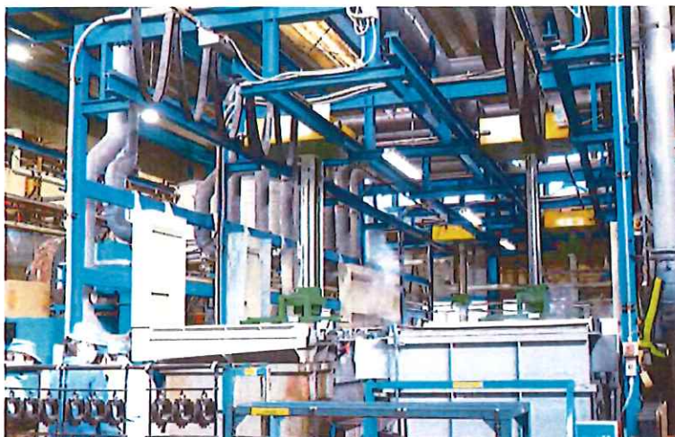
小型部品のめっき処理は、ロボットによる自動化も進めている（久喜市）
